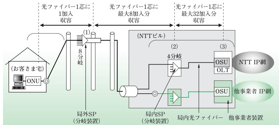
OLT (Optical Line Terminal) ・OSU (Optical Subscriber Unit) : 光信号を終端して電気信号に変換する装置・パッケージ
