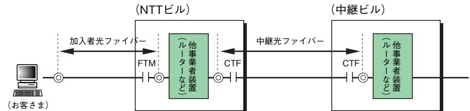
FTM (Fiber Termination Module) : 加入光ファイバー回線を収容する配線装置
